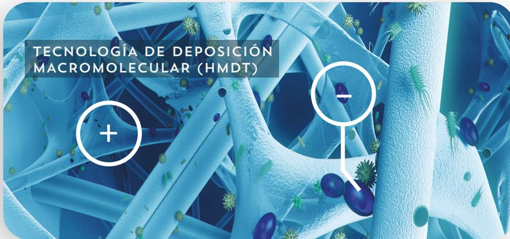
Las fibras de los filtros Aqua ✓ HD™ contienen un mineral llamado boehmita. Este mineral tiene una carga eléctrica positiva(+), en cambio los contaminantes tienen carga eléctrica negativa(-). El mineral actúa como un poderoso imán: atrae los contaminantes y los atrapa en la superficie del filtro (los adsorbe) para que no puedan escapar. **Proporcionando una filtración a escala nanoscópica.**
